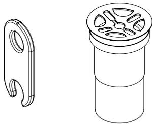
**A** Montageschlüssel in Hybridventil einsetzen
