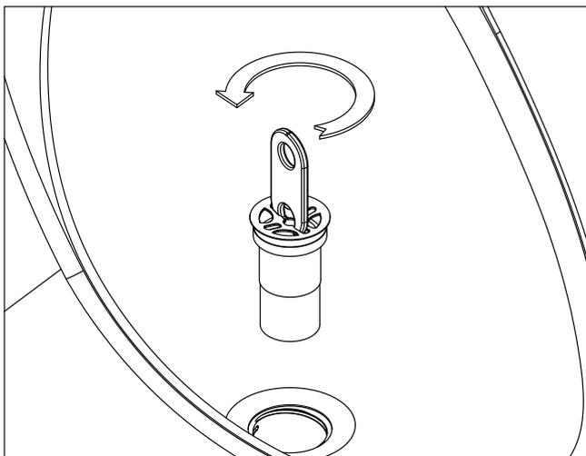
**C** Hybridventil entfernen und entsorgen
