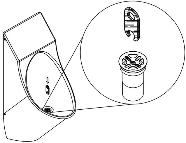
**B** Schlüssel entgegen dem Uhrzeigersinn drehen
