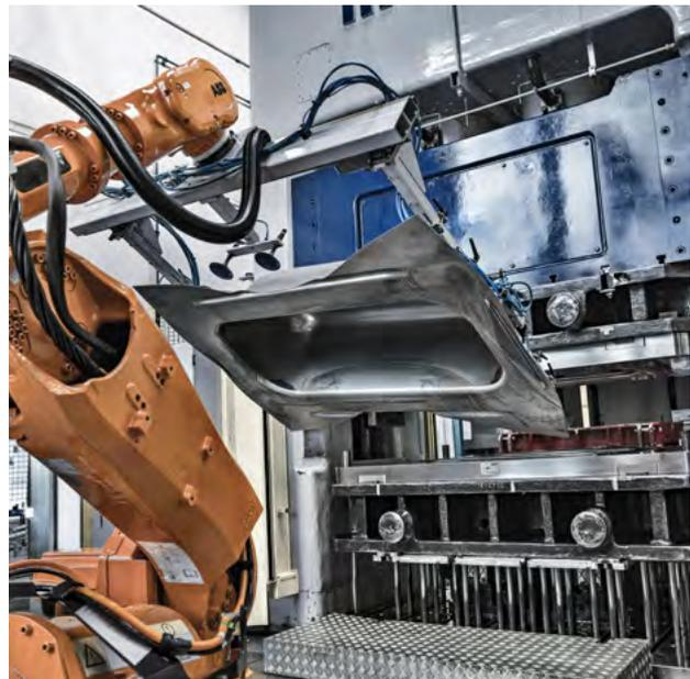
Heute werden die Rohlinge mit unserer Tiefziehpresse aus einem Stück gezogen und geformt
