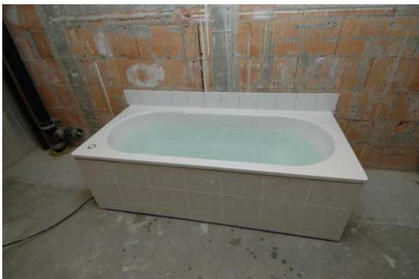
Die Badewanne wurde vom Hersteller geliefert und auf die 220 mm dicke Betonrohdecke im Messlabor der Firma Geberit montiert. Die Montage der Badewanne erfolgte nach bauüblicher Praxis. Montiert wurde die Badewanne an der Trennwand zwischen Senderraum und diagonalem Empfangsraum.
