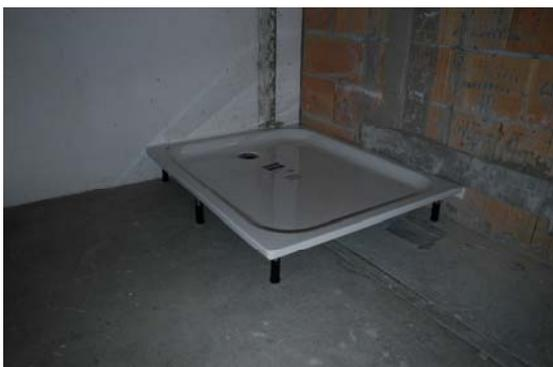
Die Stahl-Duschwanne wurde vom Hersteller geliefert und auf die 220 mm dicke Betonrohdecke im Messlabor der Firma Geberit montiert. Die Montage der Stahl-Duschwanne erfolgte nach bauüblicher Praxis. Montiert wurde die Stahl-Duschwanne auf den dazugehörenden Montagerahmen an der Trennwand zwischen Senderaum und diagonal angeordneten Empfangsraum.
