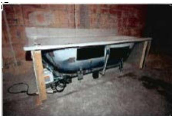
La baignoire Whirl a été fournie par le fabricant et installée sur une dalle de béton brut de 220 mm d'épaisseur dans le laboratoire de mesure de la société Geberit. La pose de la baignoire Whirl a été effectuée conformément aux pratiques habituelles. La baignoire Whirl a été installée contre la cloison de séparation entre le local d'émission et le local de réception situé en diagonale
