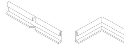
Die Bade- oder Duschwanne wird ausgerichtet und mit den Montagewinkeln für die Zargenmontage fixiert.
