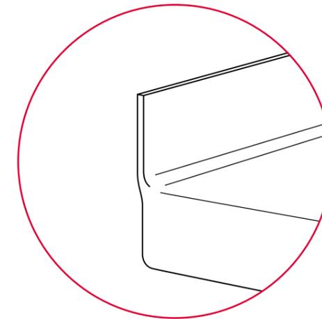
**Die Schmidlin Zarge:** Eine hygienische, langlebige und optisch ansprechende Lösung. Durch die Schmidlin Zarge reichen die Schmidlin Bade- und Duschwannen bis unter die Wandplatten und der Einsatz von Silikon im Wandanschluss wird überflüssig. Ein echter Mehrwert, der hohen Designanspruch und erstklassige Funktionalität nachhaltig miteinander verbindet.
