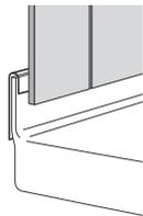
Die Schmidlin Zarge ist eine 30 mm hohe emaillierte Aufkantung des Wannenrandes, welche zur Hälfte durch Wandplatten überdeckt wird. Somit ist ein absolut wasserdichter Wandanschluss garantiert, ohne Silikonfuge.
