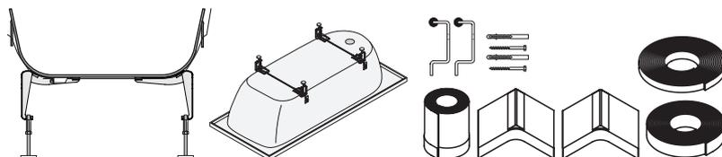
pour tous les modèles baignoires(contient: 4 pieds réglables, 2 crochets muraux, bande d'étanchéité 4 m, 2 angle d'étanchéité, bande d'isolation phonique, bande d'espacement) sauf CONTURA COMFORT LEVEL, CONTURA DUO LEVEL, HOME OVAL, LAGUNA, POOL CORNER, ROMA, SITZ, SKYLINE, STEEL CORNER
