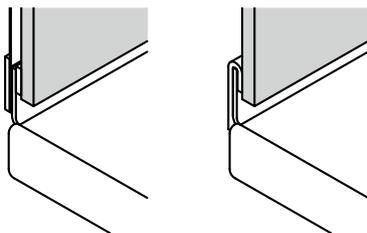
Le rebord Schmidlin est un rehaussement émaillé du bord de la baignoire ou du receveur de douche de 30 mm de haut recouvert de moitié par le carrelage mural. Il garantit un raccordement mural totalement étanche, sans joints de silicone.
