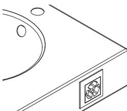
Percement d'un trou pour prise électrique, en option pour différents lavabos Schmidlin montage mural
