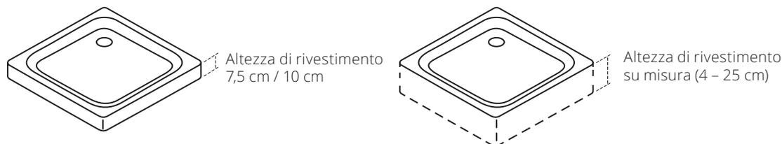
Rivestimento smaltato senza saldature sui uno, due o tre lati.
