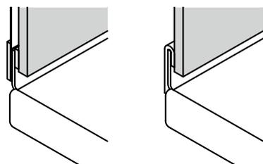
Il bordo rialzato è un prolungamento verticale smaltato di 30 mm del bordo della vasca o del piatto doccia, ricoperto per metà dalle piastrelle. Il collegamento con la parete risulta pertanto assolutamente impermeabile, senza fuga di silicone.
