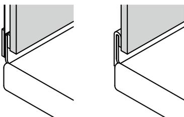
Die Schmidlin Zarge ist eine 30 mm hohe emaillierte Aufkantung des Wannenrandes, welche zur Hälfte durch Wandplatten überdeckt wird. Somit ist ein absolut wasserdichter Wandanschluss garantiert, ohne Silikonfuge.
